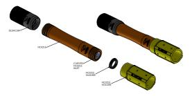
NOZZLE AND SILENCER INSTALLATION ARRANGEMENT
